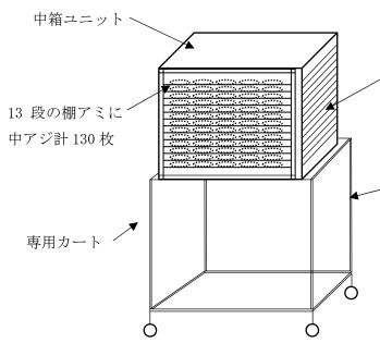
、テイストモディファイアの庫内から取り出し、 専用カートにスライドして載せる
