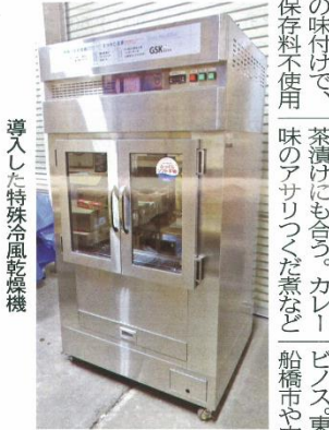
導入した特殊冷風乾燥機
